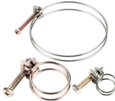
Хомуты - применяются для крепления и герметизации соединения шлангов и гибких трубопроводов. Обеспечивают надёжную герметизацию соединения. Хомуты провололочные: предназначены для толстостенных шлангов и соединений, работающих в условиях высокой вибрации, имеют винтовой зажим под ключ с головкой под шлицевую и крестовую отвертки.
